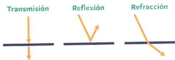
Figura 1. La radiación solar puede ser transmitida, reflejada o refractada por un cuerpo.
