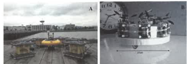
Figura 1. Diferentes grupos investigan oportunidades de aplicación de las celdas microbianas. A. Celda para uso en ambientes marinos, B. Robot Ecobot II.
