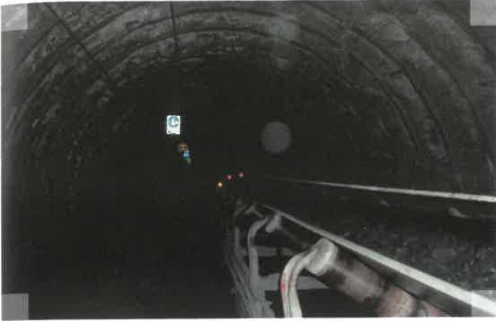
Fotografía 1. Túnel de acceso y banda de extracción del carbón en mina subterránea
