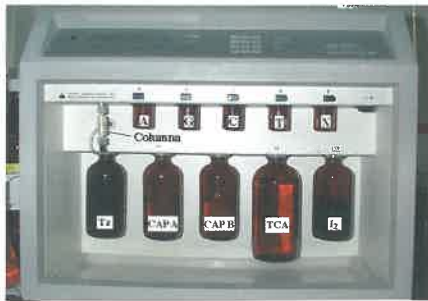
Figura 2. Sintetizador automático de ADN. Las bases nucleotídicas son adicionadas una por una a un soporte sólido localizado en una columna desechable delimitada por dos filtros. Las bases están separadas en distintas botellas. Los reactivos localizados en las botellas grandes son auxiliares para completar cada acoplamiento.
